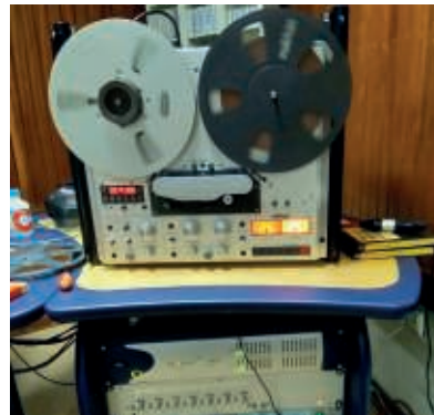
Setup geral de transcrição de fita magnética (Revox PR-99, Cabeça Butterfly two channel, Digidesign HD192)
