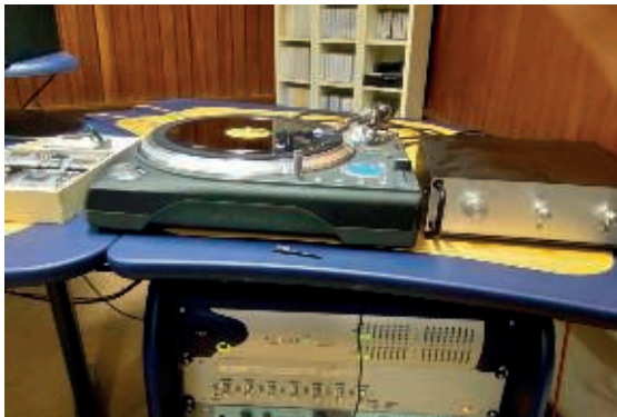
Setup geral de transcrição de discos (Numark TTX, Preamp flat, Digidesign HD192)
